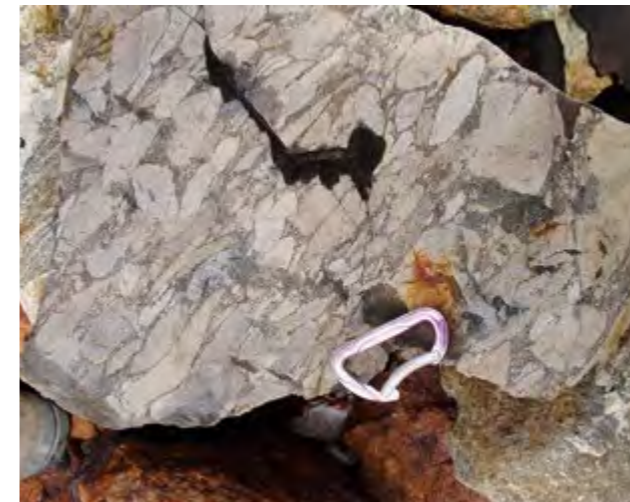
Gesteine vulkanischer Entstehung im Baugrund der Trifthütte: vulkanische Auswurfprodukte wie Bimsstein, Lavabrocken und Aschen, die als Schlammstrom («Lahar») verschwemmt worden sind.
