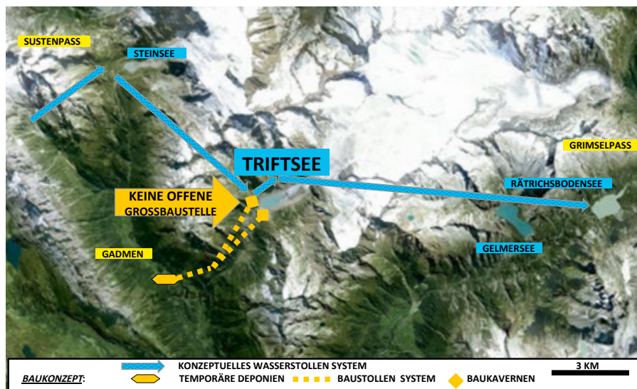
Das Konzept des Triftwasserkraftprojekts (eine Übersicht).
